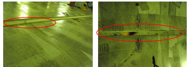
図 4 車両甲板歪みダメージの実例
