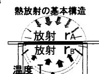
図2 上下の方向からの熱放射収支(NET)の測定
