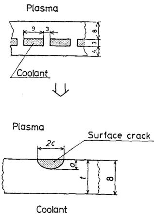
図17 リブ型核融合炉第一壁とそのモデル化
