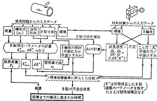
図2 き裂のある部材および構造物の健全性評価
