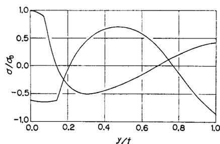
図18 熱衝撃負荷による壁面の熱応力サイクル (仮定) ( $\sigma_0=260 \text{ MPa}$ )
