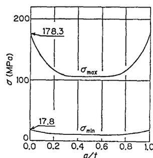
図13 仮想き裂断面上の応力分布
