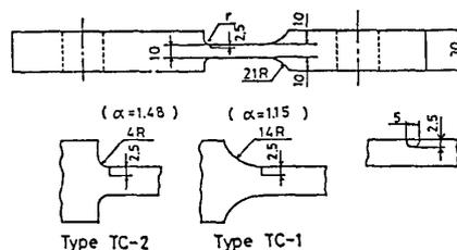
図12 表面き裂を持つ段付板
