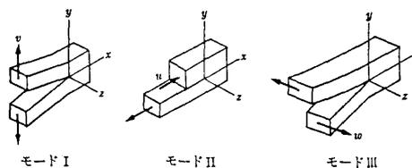
図3 基本的な3つのき裂変形様式
