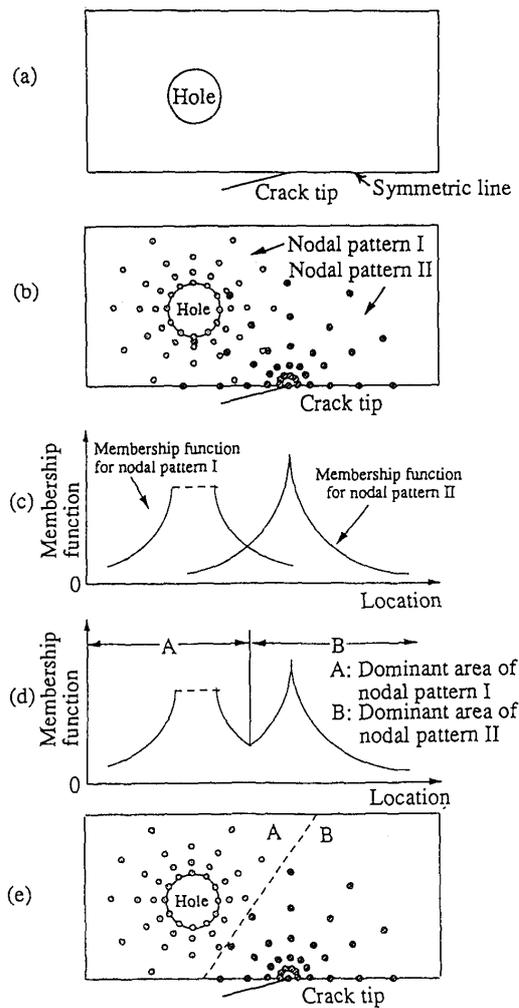
図2 あいまい知識処理手法に基づく節点パターンの組み合わせの原理
