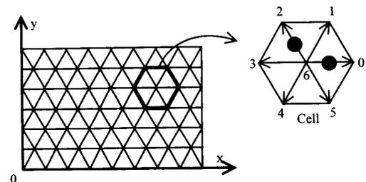
図1 FHPモデルに用いる格子とセル
