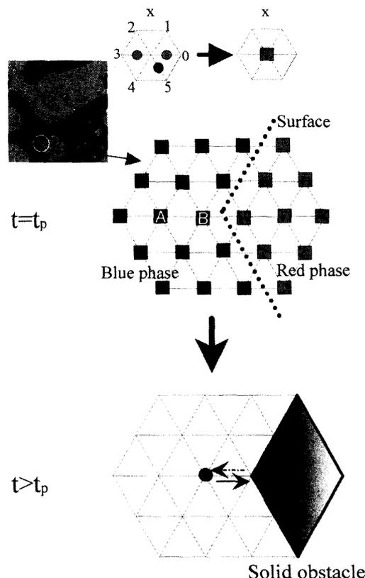
図6 ILGモデルを応用した複雑形状流路作成方法の模式図
