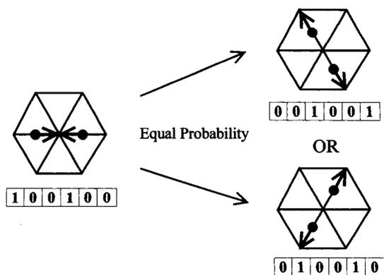
図3 FHPモデルの衝突則の一例
