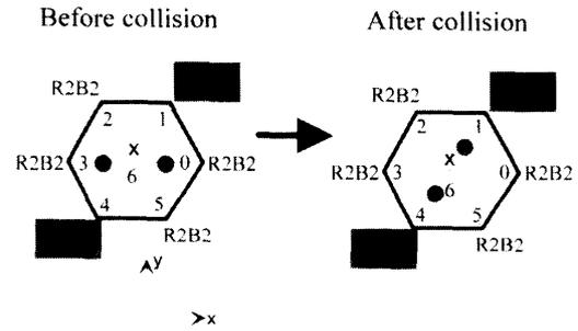
図 4 ILG モデルの衝突則の一例
