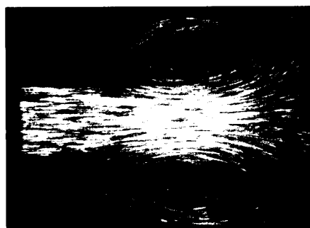
図2 急拡大管内の流れ(ピクセル露光法による可視化)
