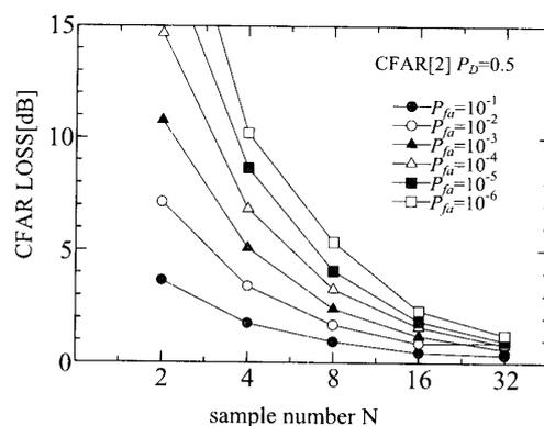
図11 CFAR[2]回路のCFAR損失
