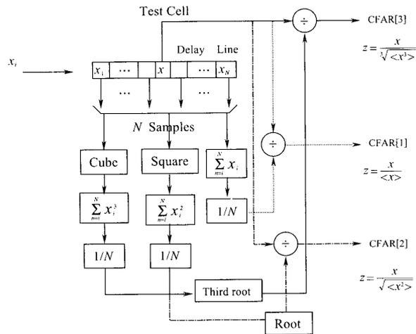
図3 CFAR[1][2][3]の処理回路
