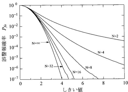
図 5 CFAR[2] 回路の誤警報確率
