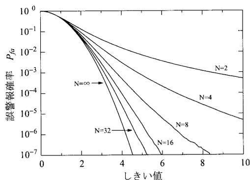
図 4 CFAR[1] 回路の誤警報確率
