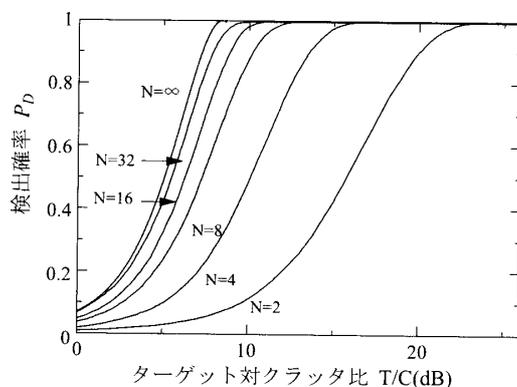
図9 CFAR[3]回路の検出確率 (誤警報確率:  $10^{-3}$ )
