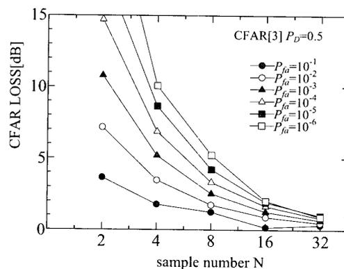
図12 CFAR[3]回路のCFAR損失
