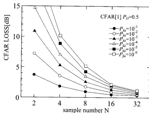
図10 CFAR[1]回路のCFAR損失
