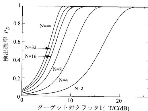
図8 CFAR[2]回路の検出確率 (誤警報確率:  $10^{-3}$ )
