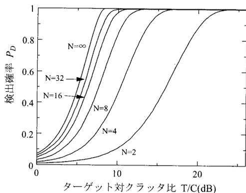
図7 CFAR[1]回路の検出確率 (誤警報確率:  $10^{-3}$ )
