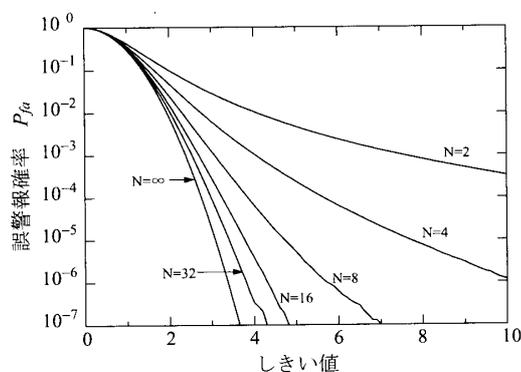
図 6 CFAR[3] 回路の誤警報確率
