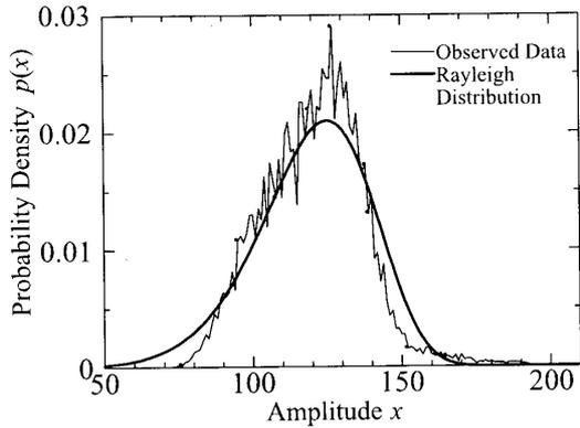
図13 ミリ波レーダにより観測された海面クラッタの分布推定結果
