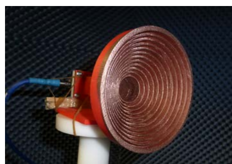
図-15 コルゲート付樹脂円錐ホーン：タイプ (b) の実測風景
