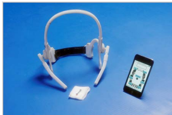
舌操作システムのヘッドセット、磁気材の舌スタッド、そしてスマートフォン。
