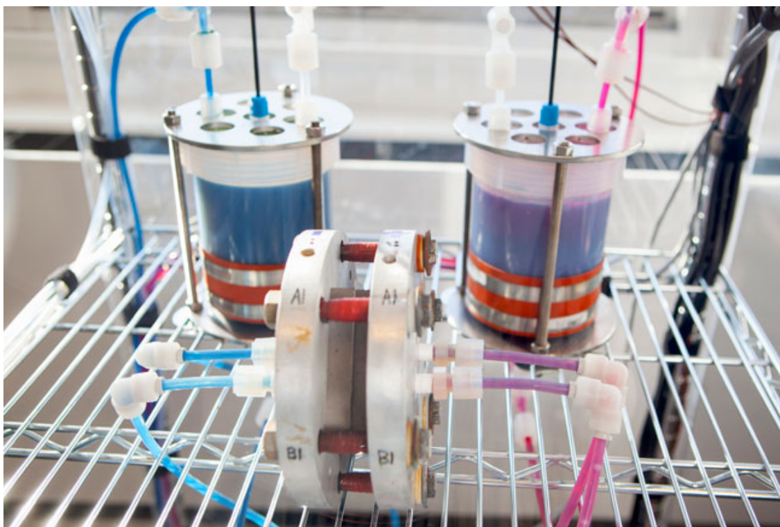
ハーバード大学 School of Engineering and Applied Sciences 内の Aziz 氏の研究室にあるフロー蓄電池の試作品(写真提供: SEAS Communications の Eliza Grinnell 氏)
