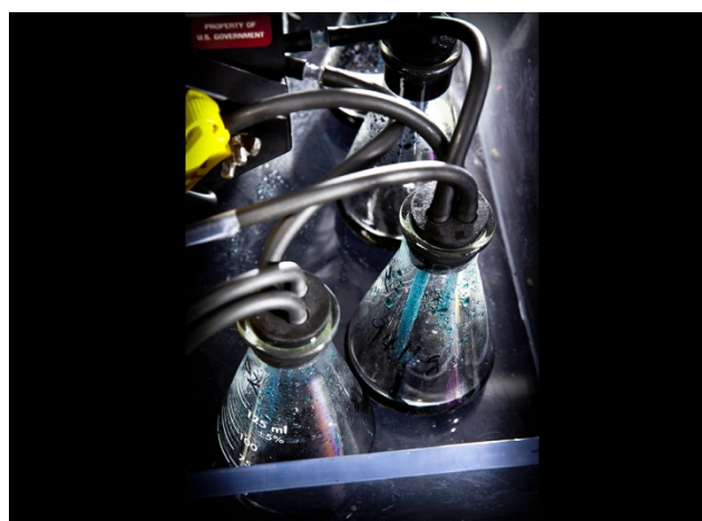
パシフィック・ノースウェスト国立研究所 (PNNL) の新型ポリヨウ化亜鉛フロー蓄電池は高いエネルギー密度を備える。サイズを縮小、コストを削減し、人口が密集する都市でのエネルギー貯蔵に最適。図は、PNNL の別のフロー蓄電池、バナジウム・レドックスフロー蓄電池の電解液。
