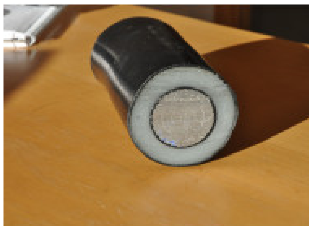
高圧ケーブルの横断面。導電性のコアは黒い保護層、白いプラスチックの絶縁層、さらに黒い保護層で覆われている。
