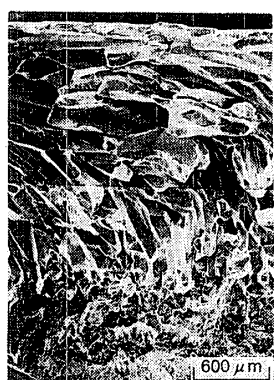
(b) Ductility-dip crack
