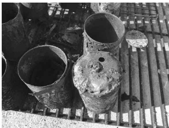
上蓋が抜けた供試体と抜けなかった供試体
