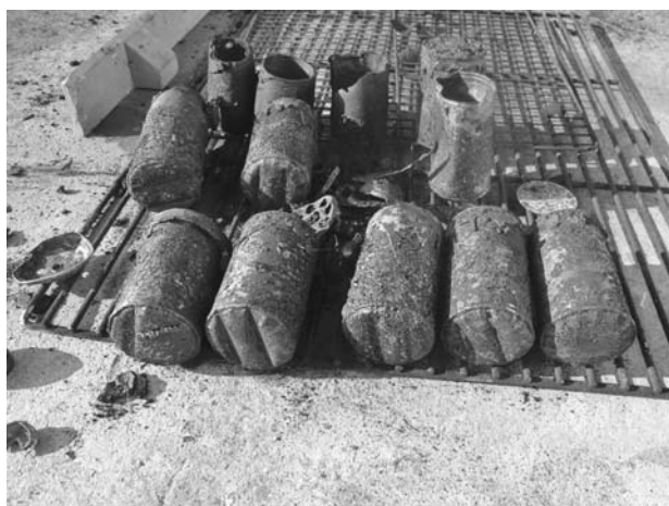
発煙浮信号の底板に残った押し跡
