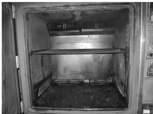
恒温恒湿槽の内部 (焼損した火工品と棚は外されている)
