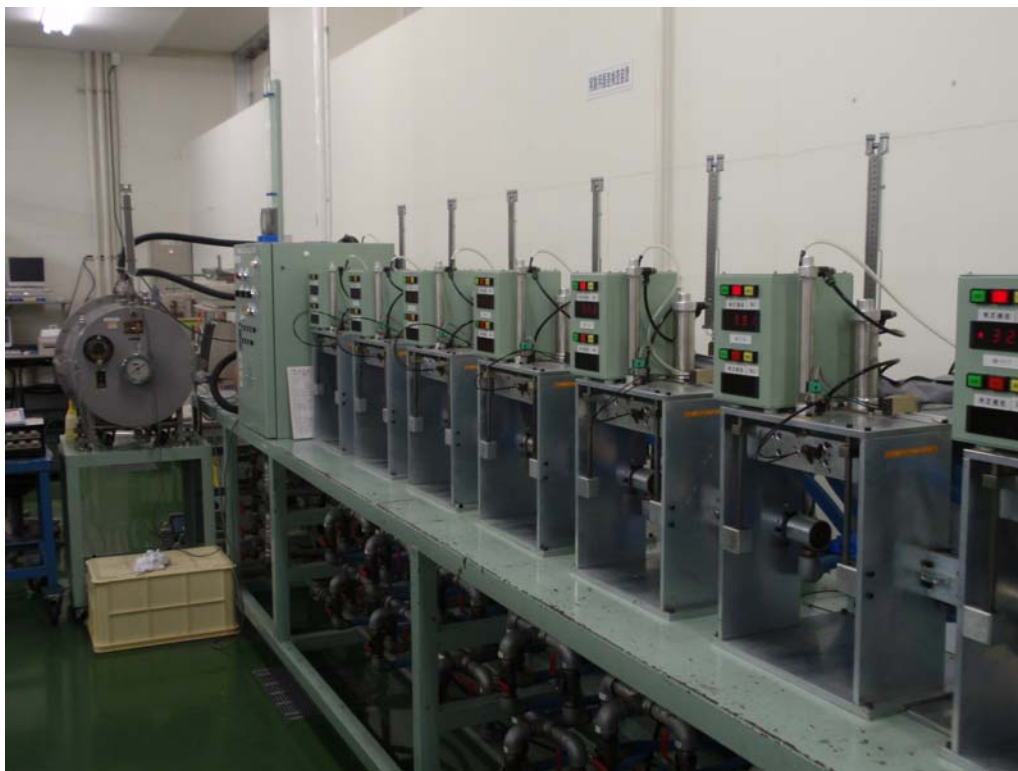
図 1 4 (写真) 器差試験設備 (指定事業者 f)
