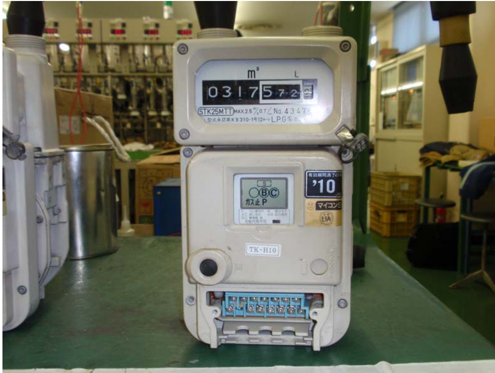
図3 (写真) LPガスメーターの外観①
