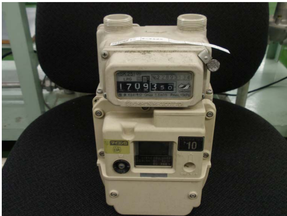
図4 (写真) LPガスメーターの外観②
