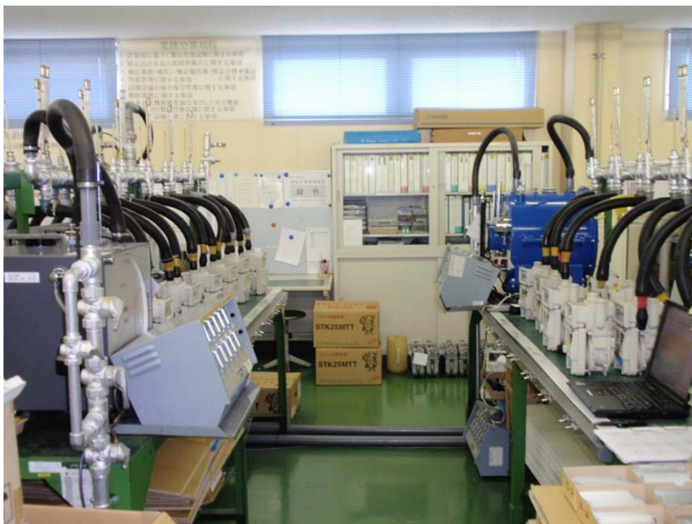
図 9 (写真) 器差試験設備 (指定事業者 a)
