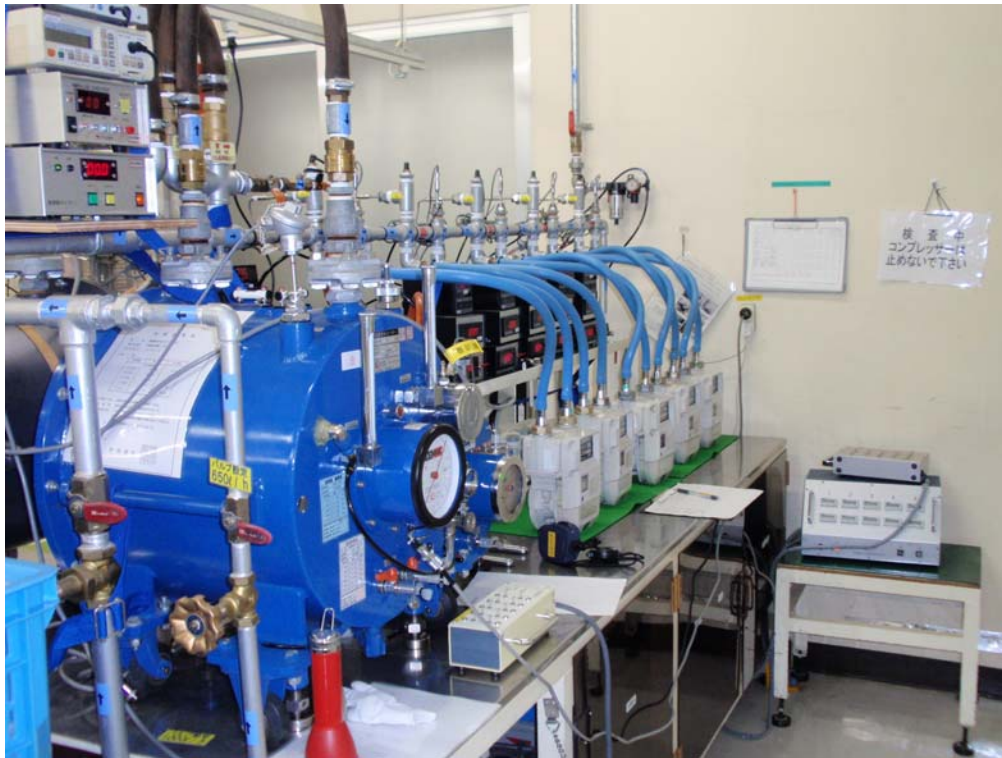
図 1 3 (写真) 器差試験設備 (指定事業者 e)
