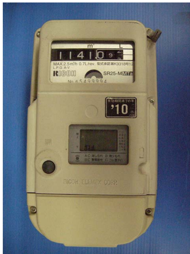
図8（写真）LPガスメーターの外観⑥
