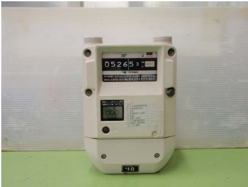
図6（写真）LPガスメーターの外観④
