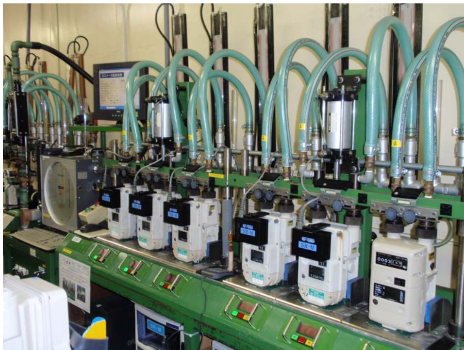
図 1 2 (写真) 器差試験設備 (指定事業者 d)
