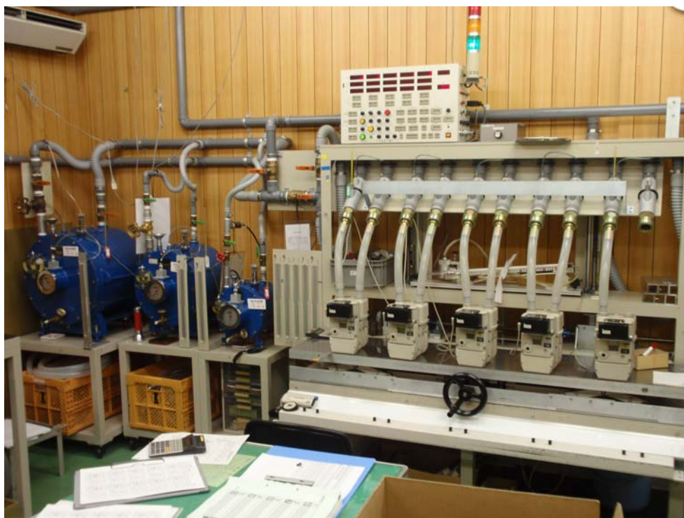
図 10 (写真) 器差試験設備 (指定事業者 b)
