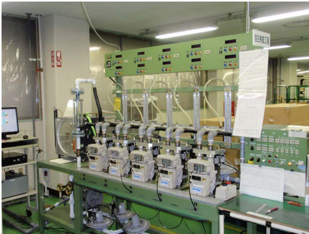
図 1 1 (写真) 器差試験設備 (指定事業者 c)
