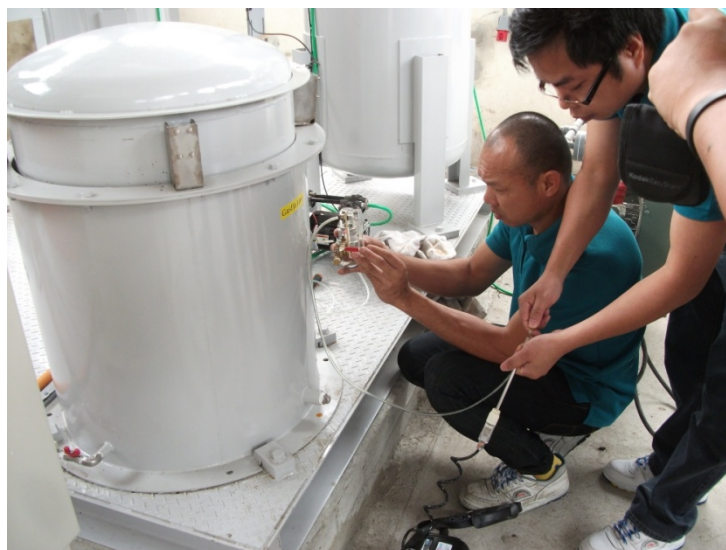
図 5-118 ポータブル GC によるメタン濃度分析風景(3)
