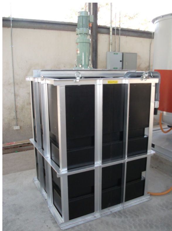
図 5-42 攪拌槽内モーターの設置状況
