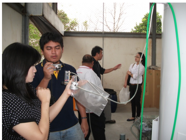
図 5-117 ポータブル GC によるメタン濃度分析風景(2)
