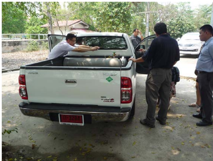
図 5-135 車載用 ANG 燃料タンクを荷台に搭載した TOYOTA Hi-Lux (LPG 仕様車)
