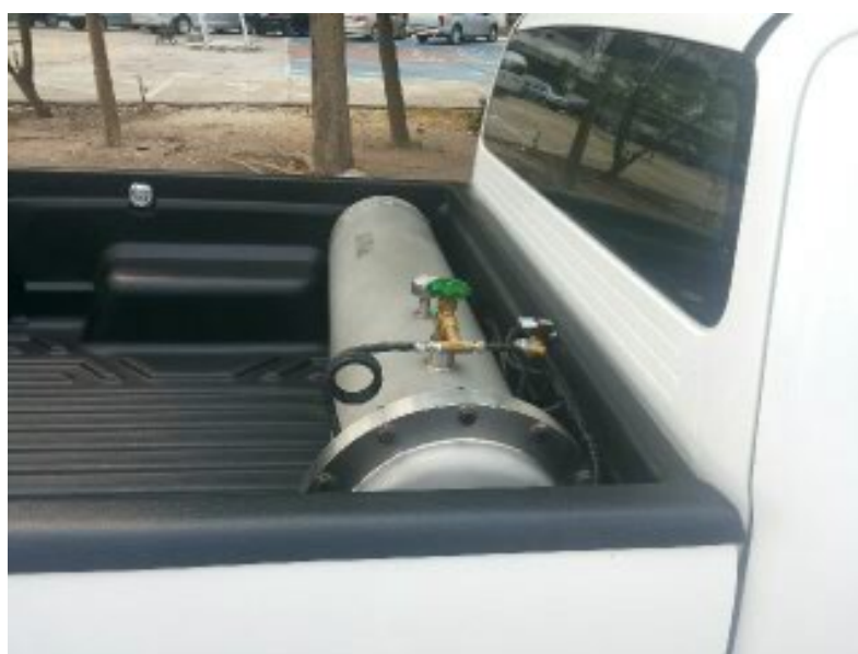
図 5-133 走行試験に用いた ANG バイオメタン自動車
