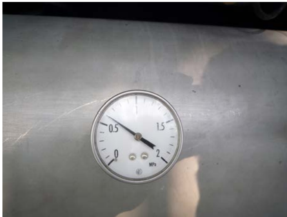
図 5-136 燃料タンク内圧力(0.6 MPa) 図 5-137 走行により圧力低下(0.5 MPa)
