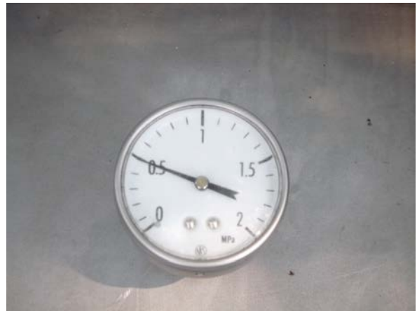
図 5-136 燃料タンク内圧力(0.6 MPa) 図 5-137 走行により圧力低下(0.5 MPa)
