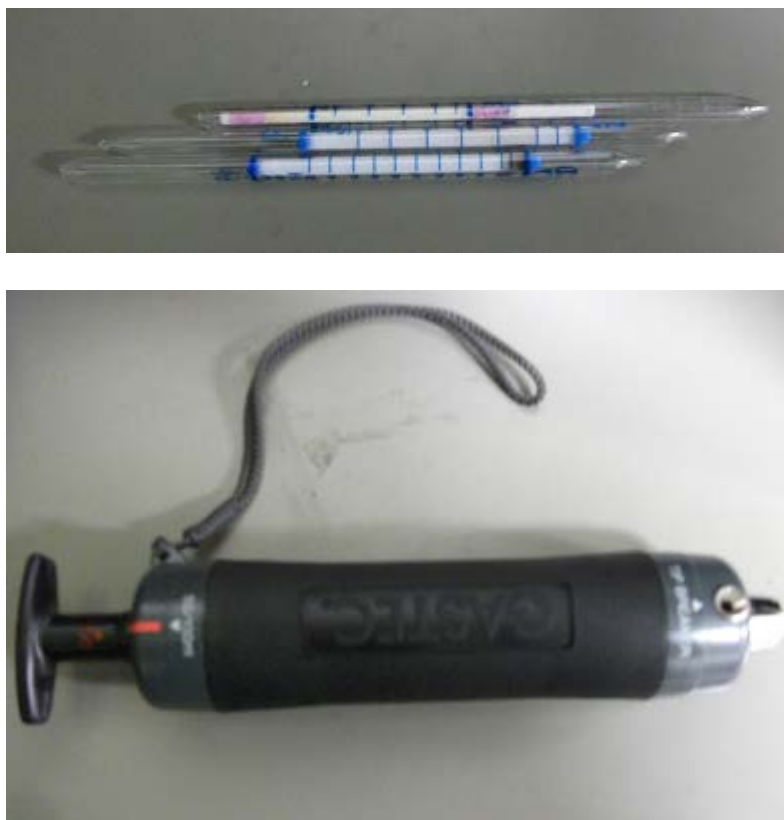
図 5-119 ガス測定用検知器（下図）と硫化水素検知管（上図）
