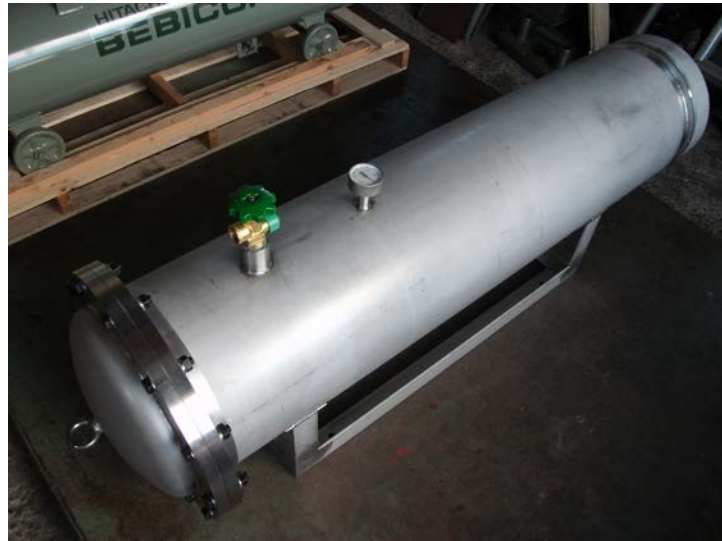
図 5-134 バイオメタン自動車用貯蔵タンク
