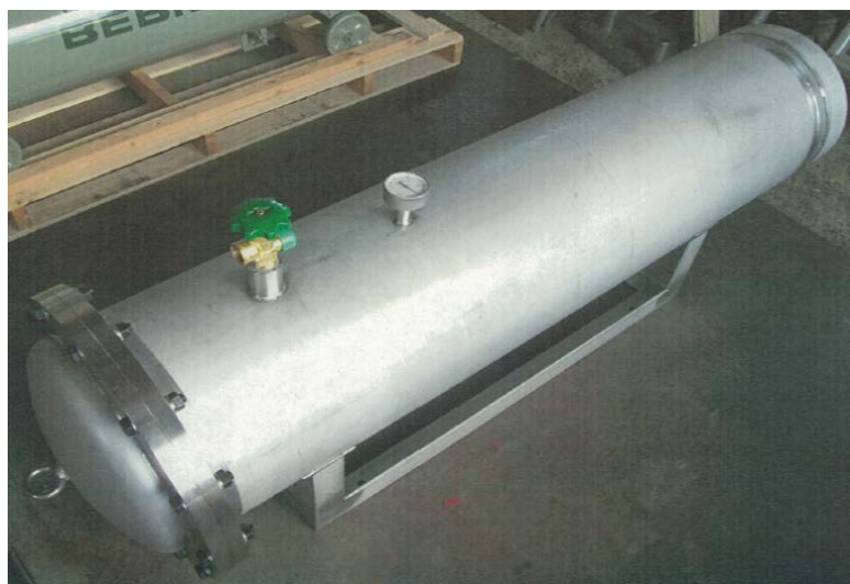
図 5-70 車載用 ANG 燃料タンク
