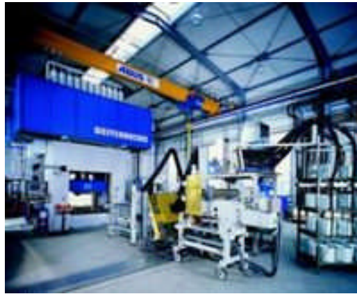
図 22 フラウンホーファーにおける SMC 設備
