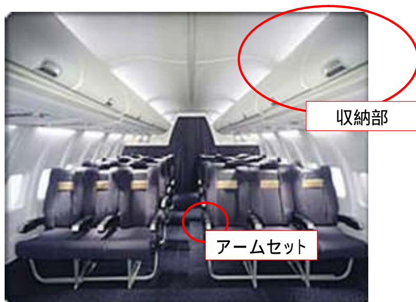
図 26 ボーイング社におけるリサイクル炭素繊維の適用箇所の例 出所) ボーイング社 HP より三菱総合研究所作成
