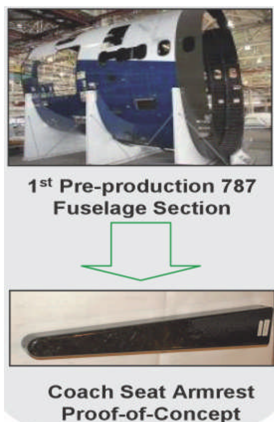
図 27 航空機のクローズドループの例 出所) ボーイング社資料「Aircraft & Composite Recycling」より抜粋
