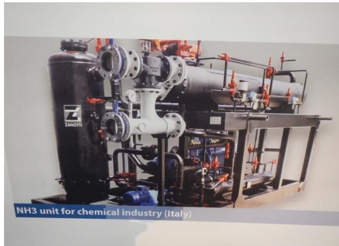
図 3.2.5 アンモニア冷媒使用のチラー (Zanotti ,Chillventa2016 での紹介展示)
