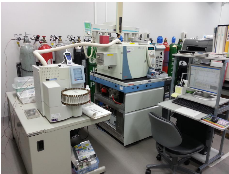
図 1 新規の TD/GC/IRMS システム
