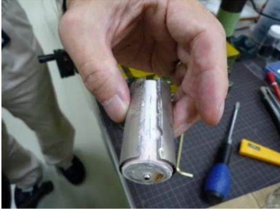
図 1 Fe 系電池のドライルーム内電極取出しの様子
