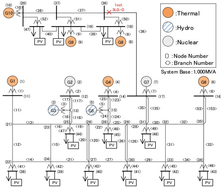
図 4.5 PV が連系された EAST10 機系統
