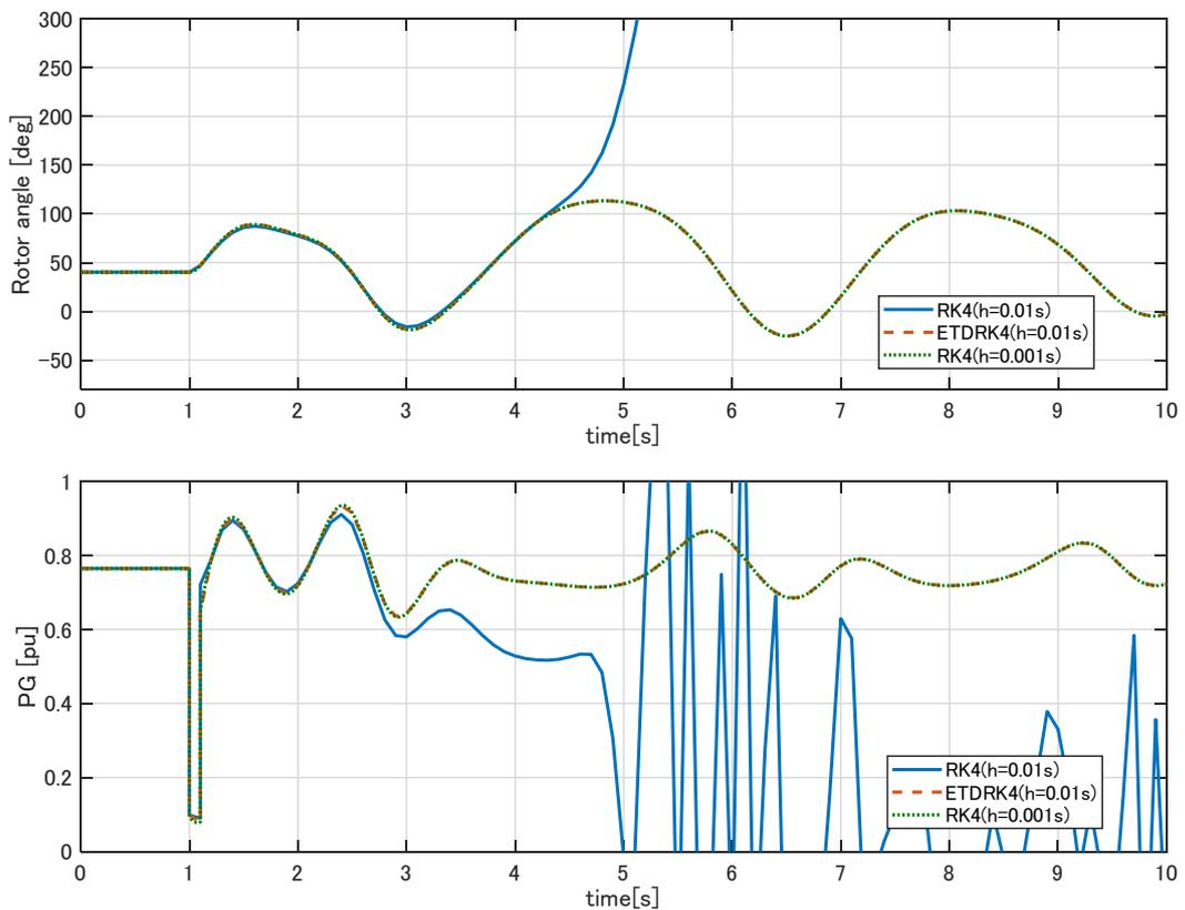
図 4.3 ケース B のシミュレーション結果 (G8 の内部相差角と有効電力出力 PG)
