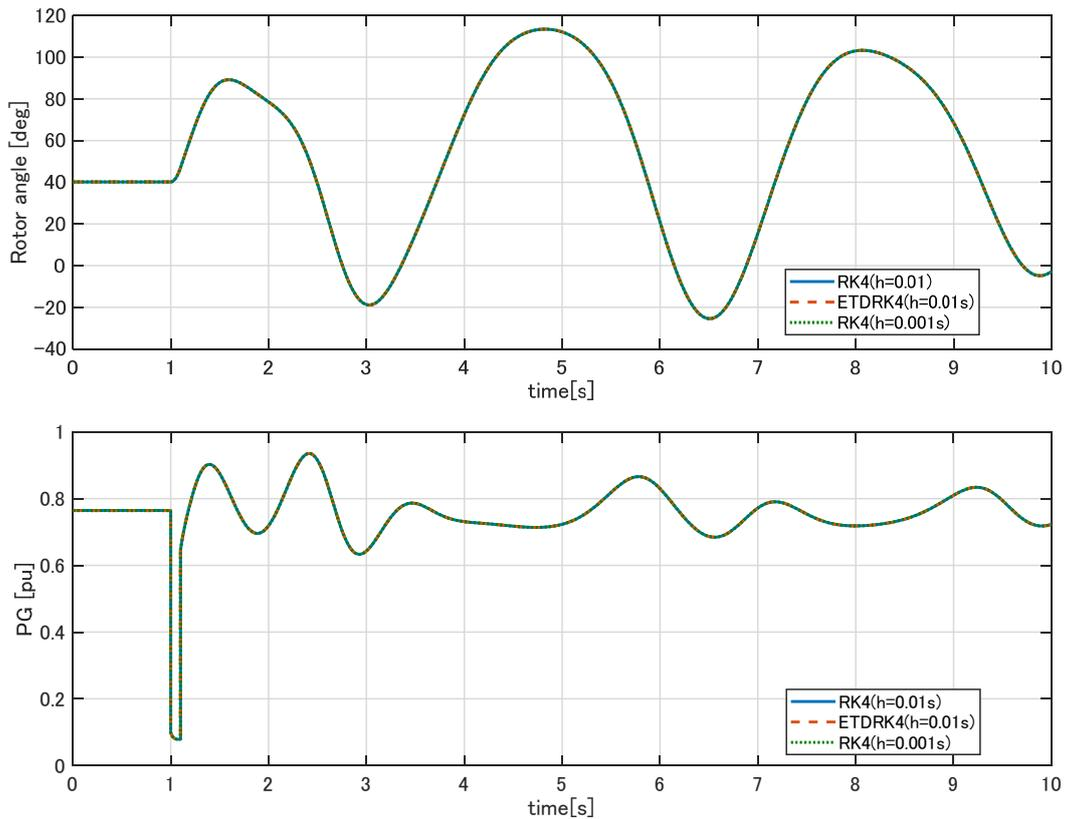
図 4.2 ケース A のシミュレーション結果 (G8 の内部相差角と有効電力出力 PG)
