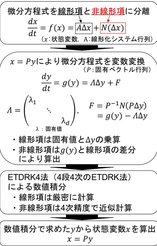
図 1 開発手法の概要\*1 (ETDRK 法を用いた数値積分の計算手順)
