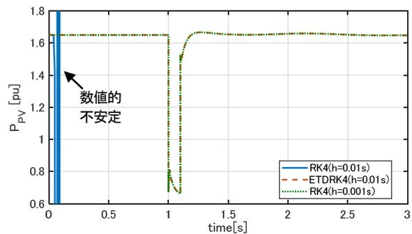
図 3 PVがある EAST10 機系統での解析結果 (PV#Node18 の有効電力出力)
