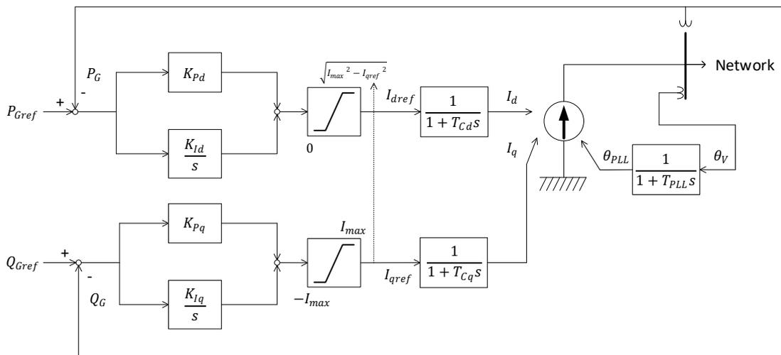
図 4.6 PV のインバータ制御系モデル
