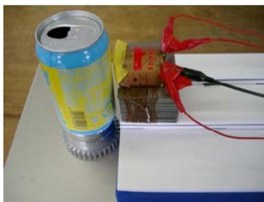
図10 回転確認実験 (ロータとステータの距離と回転との関係を確認する)
