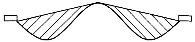
図-12 わだち掘れ面積
