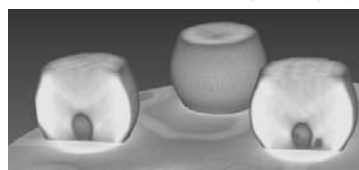
図8 ボイドのあるハンダボールのCT立体図
