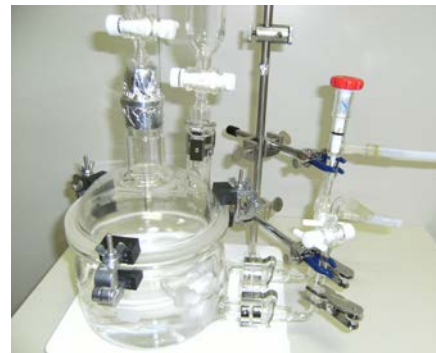
写真 拡散チューブ方式連続発生装置の容器部
