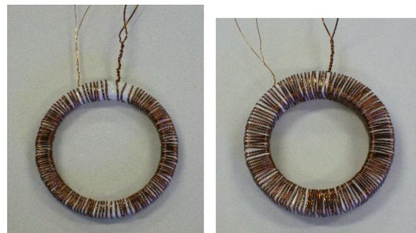
a) 直接コイル巻きした試料 b) ケースに入れてコイル巻きした試料
