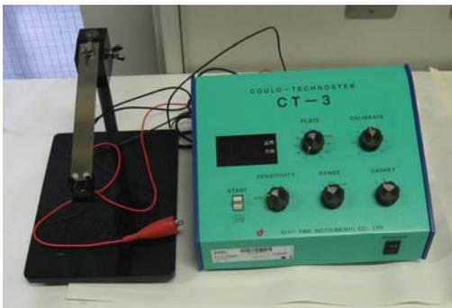
図1 電解装置(電解式膜厚計)
