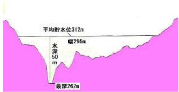
図9 熊野川ダム断面図
