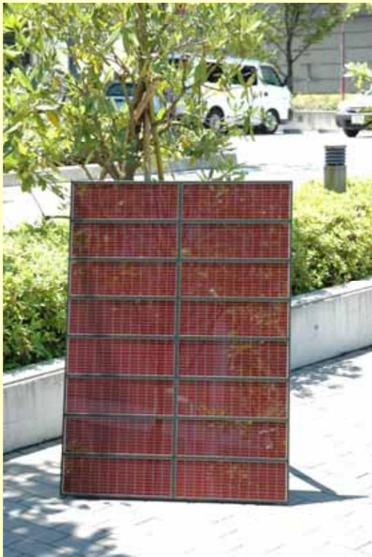
410mm × 140mm の単セルを 16 枚組み合わせた 1,190mm × 840mm の大型パネルモジュール
