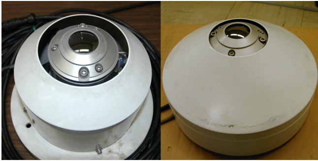
写真1 CG4 付属ファン形状の違い 左：PREDE 社製，右：Kipp & Zonen 社製。
