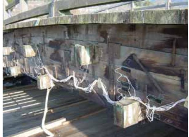
写真12 実橋実験におけるひずみ計測
