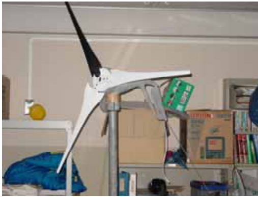
図1 小型風力発電機の外観
