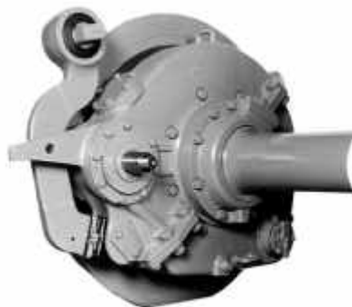
JR 西日本223系2000番代電車用主電動機
