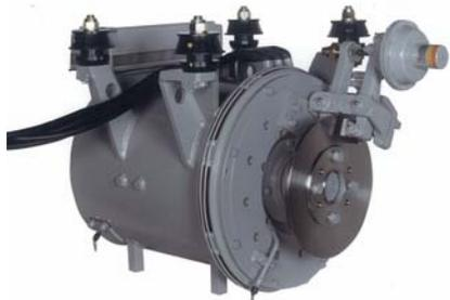
図6 主電動機外観
