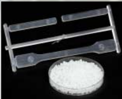
ポリ乳酸（手前）と成形加工した樹脂。より透明で厚みを持たせる加工技術の開発を進めている。
