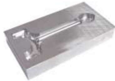
図2 小型コンロッド形状キャビティ加工
