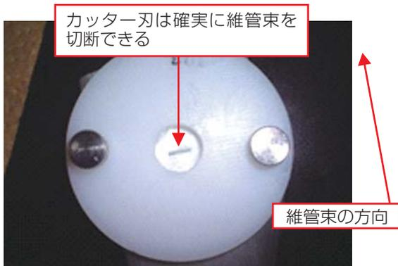
図4 カッター刃貫通後の固定台のネギ(中央の円内)
