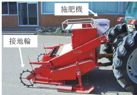
図1 施肥機を装着した整畦植込み機
