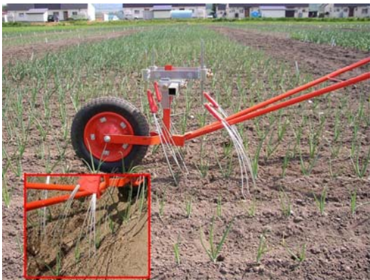
写真2 タイン式除草機 (囲み内:タインによる除草状況)
