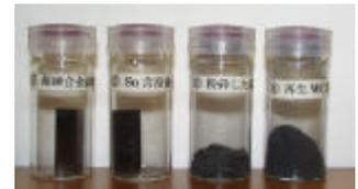
左から超硬合金、Sn含浸した超硬合金、それを粉碎した試料、再生WC粉末
