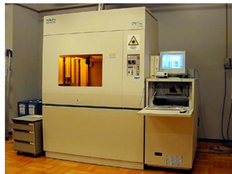
**設備名 万能材料強度試験システム**
