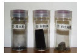
左から還元粉、再生WC粉末とCo粉末の混合圧粉体、それを焼結した再生超硬合金
