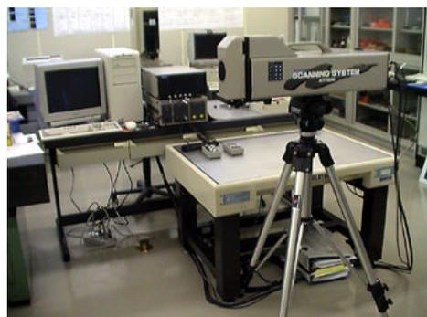
**設備名 製品解析用三次元モデル試作装置**
