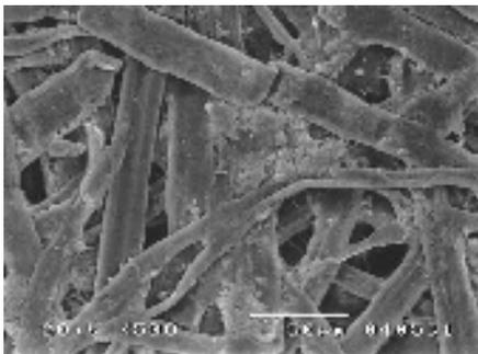
PS 焼却灰を内添した紙の電子顕微鏡写真
