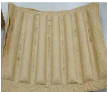
試作した紙製緩衝材、固定材
