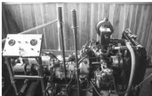
象の排泄物から発生するメタンガスを燃料とする農業用ウォーターポンプ
