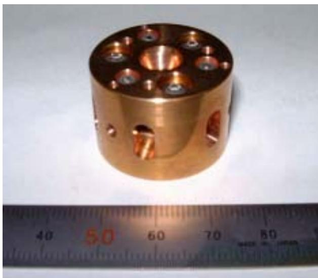
図 1. 本研究経費で製作したダイヤモンドアンビル高圧セルの写真。(株)協和製作所製)
