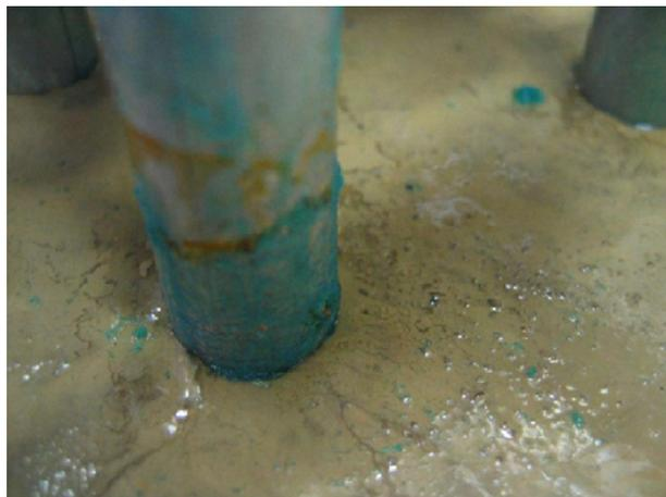
写真1 加振後の杭周地盤の状況(粘土地盤)
