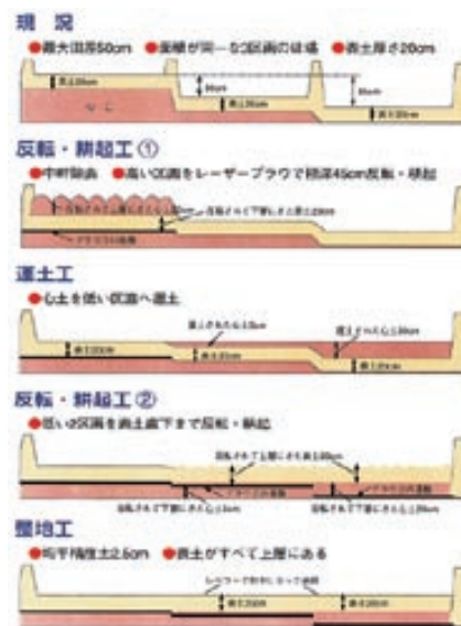
図1 反転均平工法の概要
