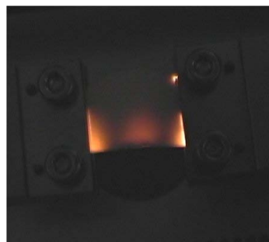
フィルム状試料に圧縮応力を加えた時の発光の様子
