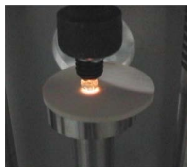
微小ガラス球を押しつけた時の発光の様子
