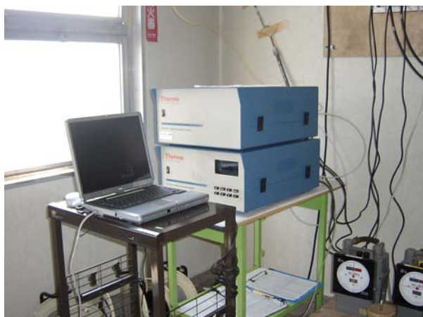
保健環境研究所屋上に設置した硫酸塩濃度連続測定装置
