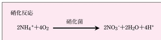
図3 KPパールによるアンモニア性窒素の除去
