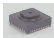
CMOSカメラモジュール (LZ0P3908) (タテ11mm) × (ヨコ11mm) × (タカサ5mm) 容積:0.6cc
