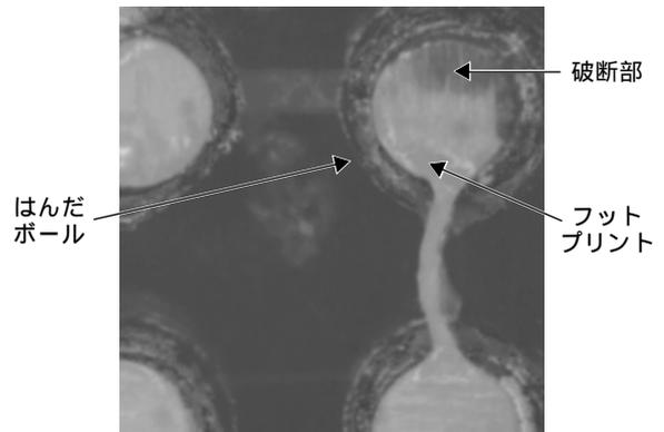
(b) 落下衝撃によるはんだパンプの破断部
