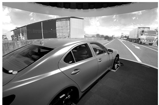
図-5 ドーム内の実車と360度スクリーン Fig.5-Real vehicle in dome and 360° screen.
