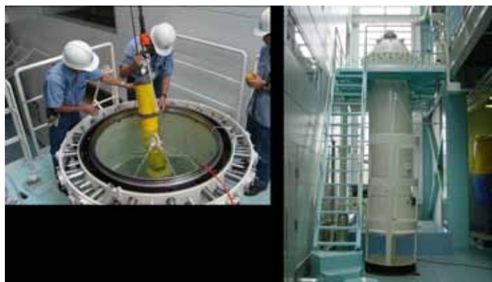
図 - 5 フロートのバラストニングと高圧タンク (海洋研究開発機構むつ研究所)
