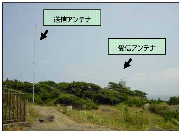
図 - 1 海洋短波レーダー送受信アンテナ(野島崎局)
