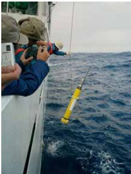
図 - 6 フロートをロープで吊り下ろす方法
