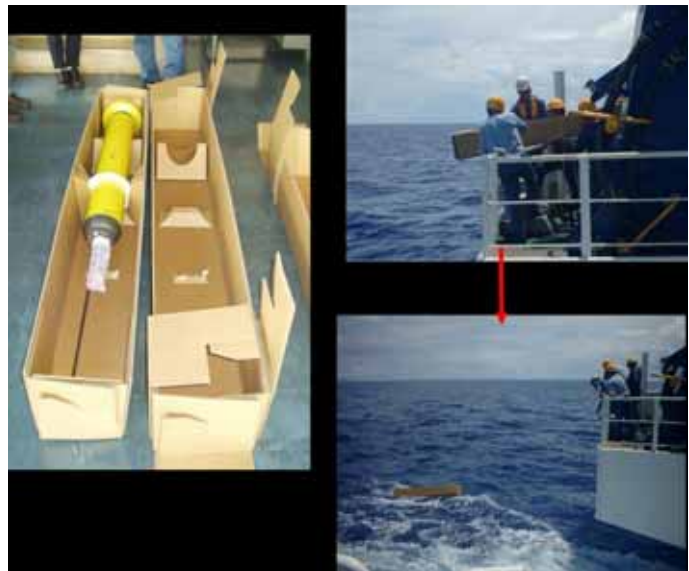
図 - 7 航走中の船からフロートを投入する方法
